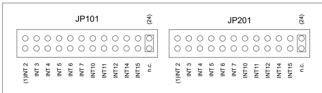
Durch Setzen jeweils eines Jumpers wird den Kanälen A und B jeweils eine der IRQ-Leitungen 2, 3, 4, 5, 6, 7, 10, 11, 12, 14 oder 15 zugewiesen.
