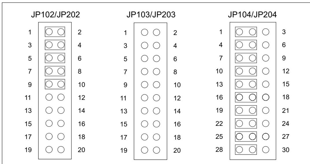
Durch das Setzen der Jumper 11-12 und 13-14 an JP102 bzw. JP202 können die Handshake-Signalleitungen DSR, DCD und DTR miteinander verbunden werden.
