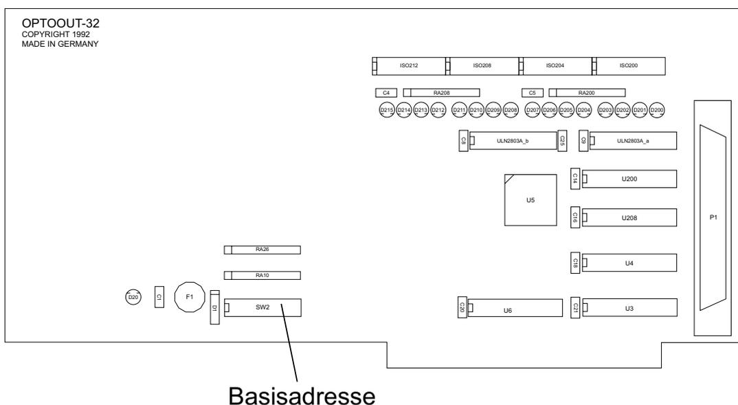
Die Interfacekarte OPTOOUT-16<sub>STANDARD</sub> decodiert die Adressleitungen A4 bis A11. Für die Basis-Portadresse sind die Adressleitungen A4 bis A9 relevant, da in den PC's nicht der volle Adressbereich ausdecodiert wird. Die Dip-Schalter der Adressleitungen A10 und A11 müssen immer ON sein.
